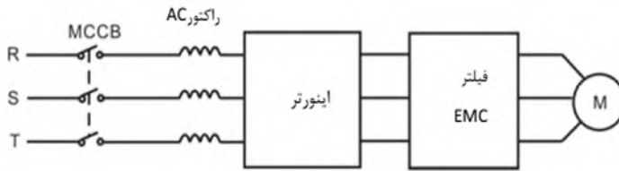
نصب فیلتر EMC در خروجی درایو
